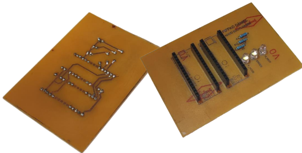
10.1.3. ábra: Az „otthoni módszerekkel” készített bootloader programozó áramkör.
