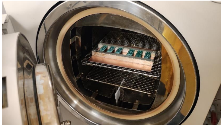
16.2.1. ábra: Áramkörök a HAST kamrában
