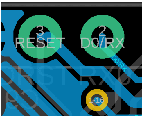
8.5. ábra: A RESET furathoz nem derékszögben csatlakozó vezeték
