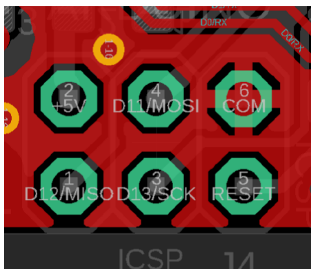
8.3. ábra: Hordozó széléhez túl közel nyúló rézrajzolat
