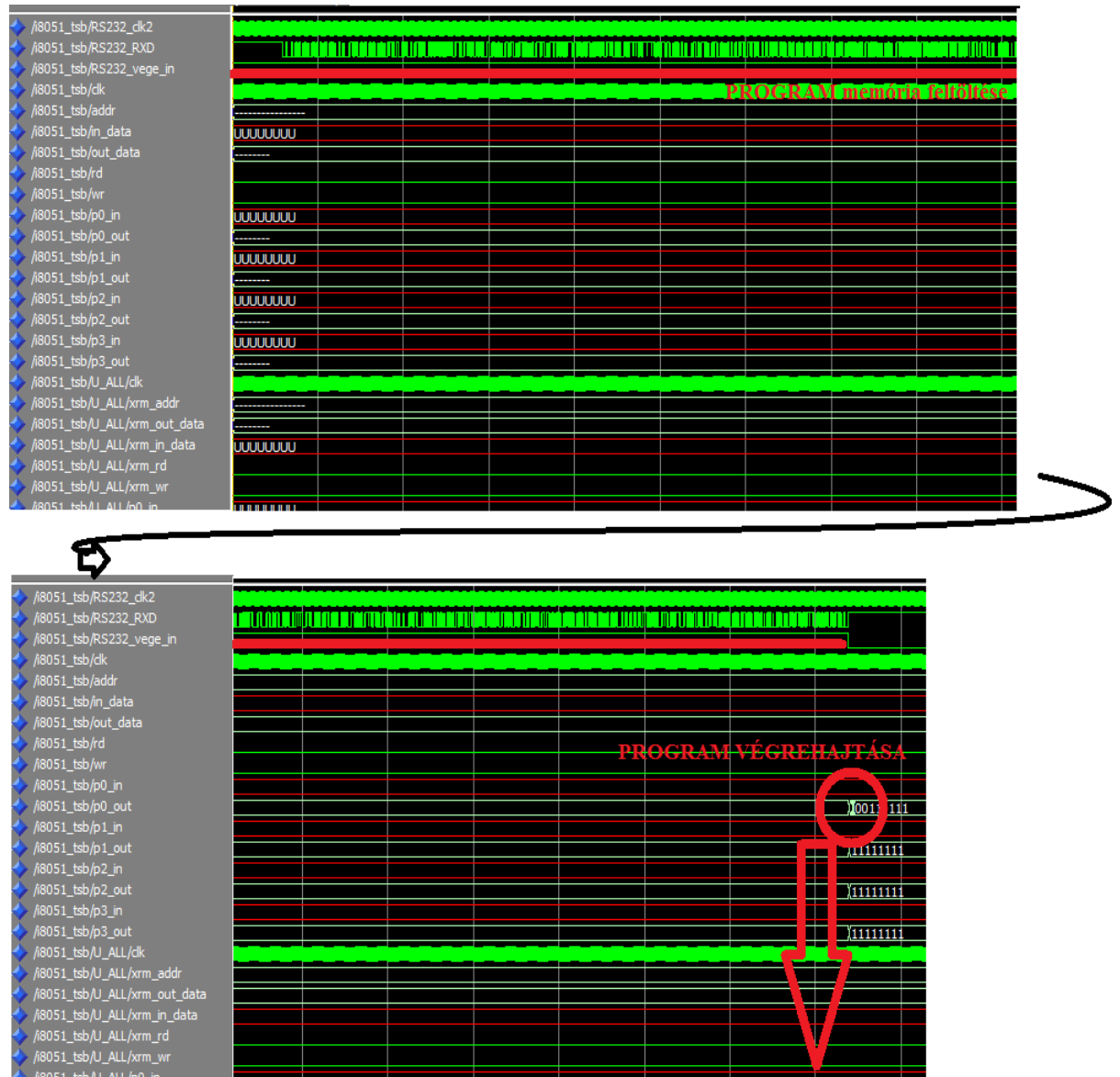
23. ábra: A mikrokontroller programmal történő feltöltésének és annak végrehajtásának szimulációja
