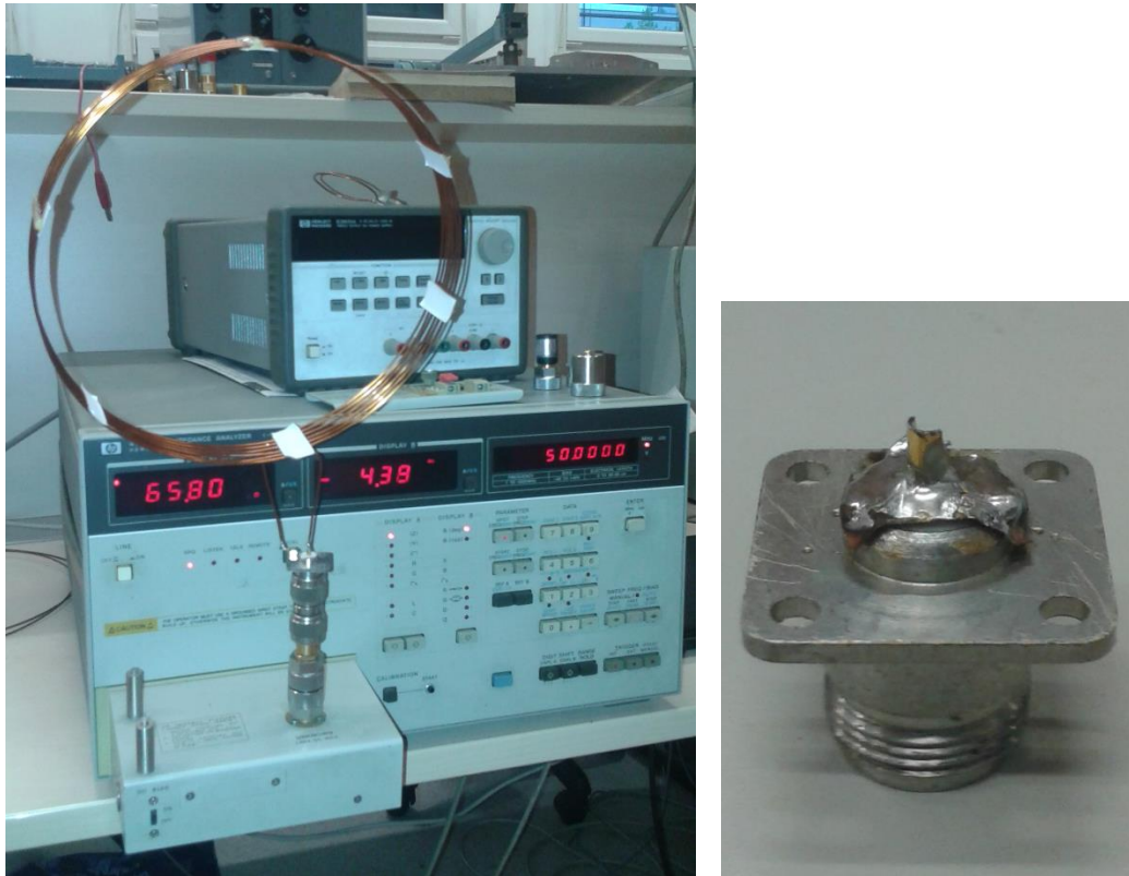
4-12. ábra, A mérési elrendezés, és a rövidre zárt N-csatlakozó
