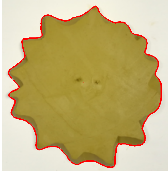
4.4. ábra. A kontúr detektálása egy konkrét szeletfelvételen Marching Squares algoritmussal.
