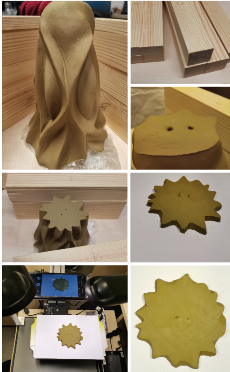
3.1. ábra. A folyamat lépéseinek szemléltetése a fizikai modelltől a fényképezésig. Látható az elkészült modell, amit a későbbiekben rekonstruálni szeretnénk, az állvány építéséhez használt elemek, illetve a referencia lyukak kijelölése. Ezt követi a szeletelés, a szeletek rögzítése és lefényképezése, az eredmény pedig a kapott képek összessége.
