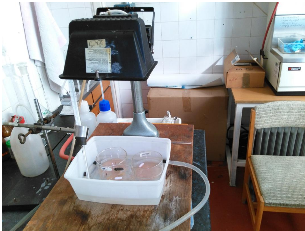
8. ábra: Az oldatban történt fotokatalitikus tesztek során alkalmazott, házilag összeállított mérési elrendezés.
