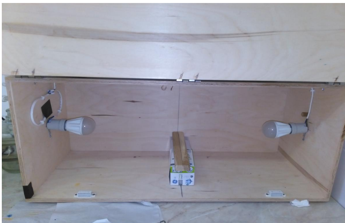
7. ábra: a látható fényben végzett fotokatalitikus vizsgálatokhoz használt, házilag gyártott mérési elrendezés
