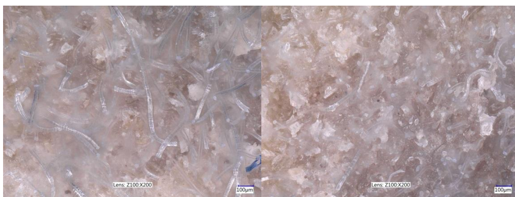
21. ábra Hibrid kompozitok törési felülete (a) kapcsolóanyag nélkül és (b) kapcsolóanyaggal (20 m/m% faliszt, 20 m/m% PET-szál tartalom mellett).
