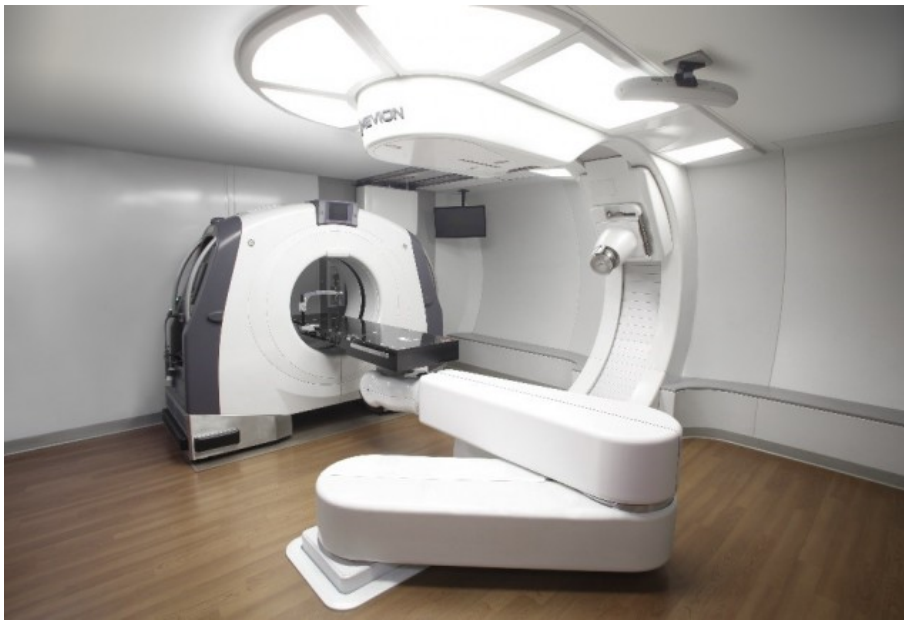
4. ábra. Egy proton kezeléshez használt készülék. A képen megfigyelhető, a beteget egy minden irányba mozgathatni képes robotkar, és a háttérben látható egy komputertomográf is [3].
