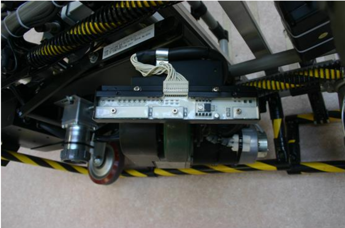
28. ábra Creform vontatótargonca kerékelrendezése a mágnessenzorral
