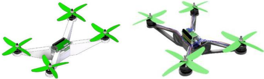
5. ábra: A drón sárkányszerkezete áttervezés előtt és utána [5]
