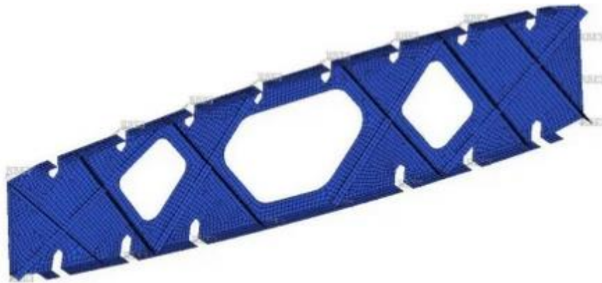
4. ábra: Topológiailag optimalizált szárny merevítő borda [3]
