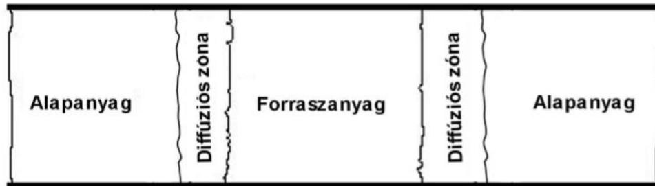
6. ábra: A forrasztási zónák; Forrás: [A6]
