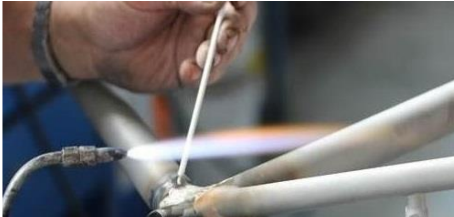
3. ábra: Keményforrasztás (lángforrasztás); Forrás: [A4]
