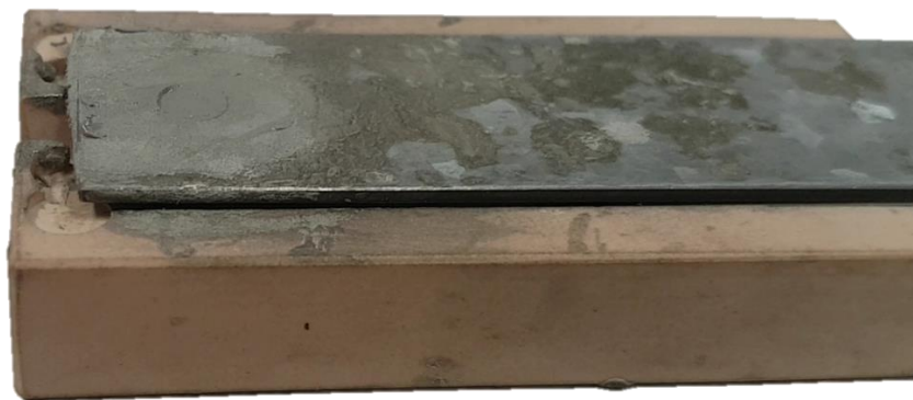
34. ábra: A forraszpaszta felviteléhez használt eszközök használat közben
