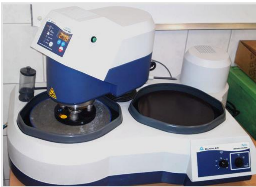
28. ábra: Buehler Beta 2 csiszoló-polírozó gép; Forrás: [A28]
