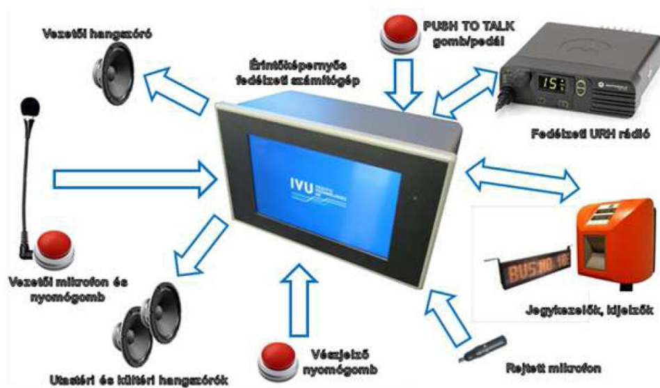
11. ábra Járműfedélzeti rendszer (OBU) (Forrás: Gelencsér László A forgalomirányítás és utastájékoztatói rendszer fejlesztése 2012.11.10)
