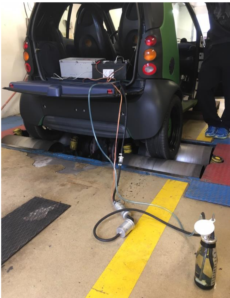
2. Kép: elfogyasztott tüzelőanyag mennyiség megállapítására használt mérőrendszer 9
