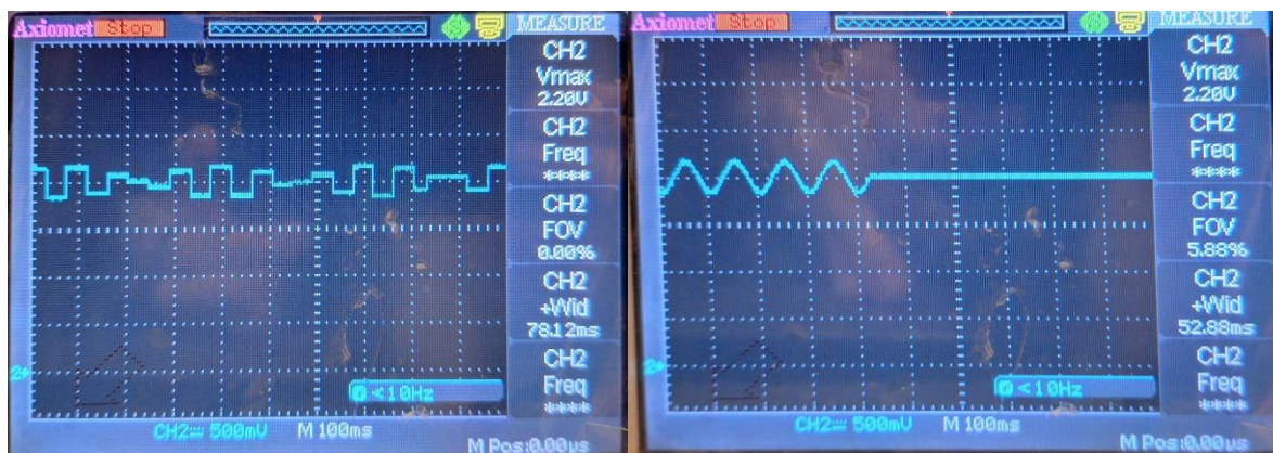
19. ábra Kiadott analóg 10 Hz-es szinusz jel valós időbeli értéke alacsony, 9600 -as (bal) és magas, 115 200-as (jobb) baud értékek esetén egy oszcilloszkópon mérve.
