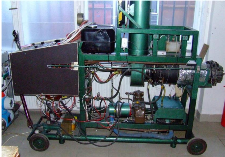
6. ábra: TKT-1 egyáramú, változtatható fűvocsővel rendelkező gázturbinás sugárhajtómű [10].
