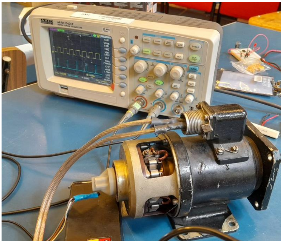
13. ábra Az oszcilloszkóp alkotta kép a mérés során értelmezett jelekről, sárga színnel a Hall-szenzor által mért, fordulatszámmal arányos jel, kék színnel pedig a vezérlő jel látható.
