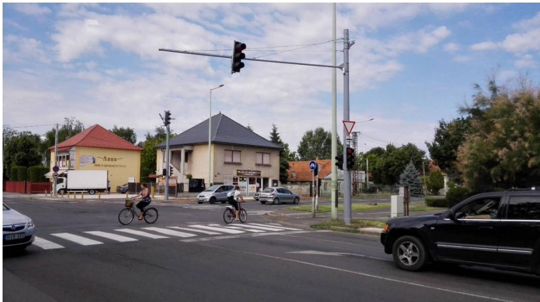
9. ábra: Kerékpáros átvezetés felfestés nélküli gyalogátkelőhely (forrás: saját fénykép)
