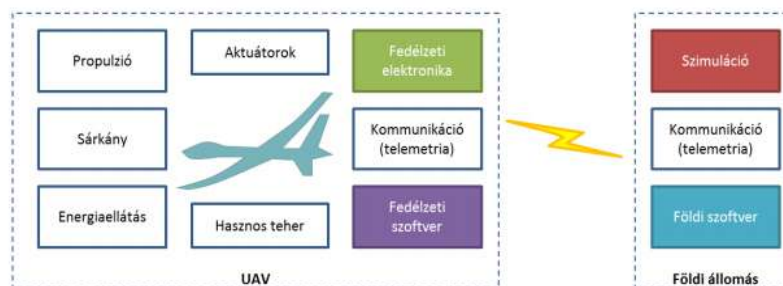
1. ábra: Egy pilóta nélküli repülőgép fontosabb elemei [52]
