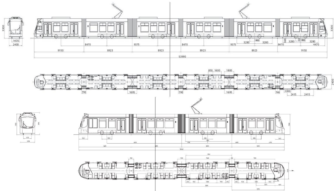
2. ábra Siemens Combino műszaki rajz (forrás: http://www.ljplus.ru/img4/t/o/toman_k/combino_budapest_and_mst.jpg )
