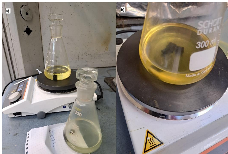
6. ábra A lombikok fél órával a hőmérséklet kísérlet kezdete után (a). A rétegek szétválása a 80 °C-ra melegített oldószerkegelyben 2 órával a kísérlet kezdete után (b).
