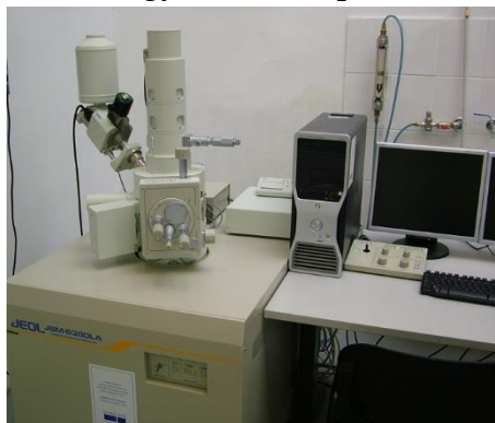
2. ábra JEOL JSM 6380LA típusú pásztázó elektronmikroszkóp [26].
