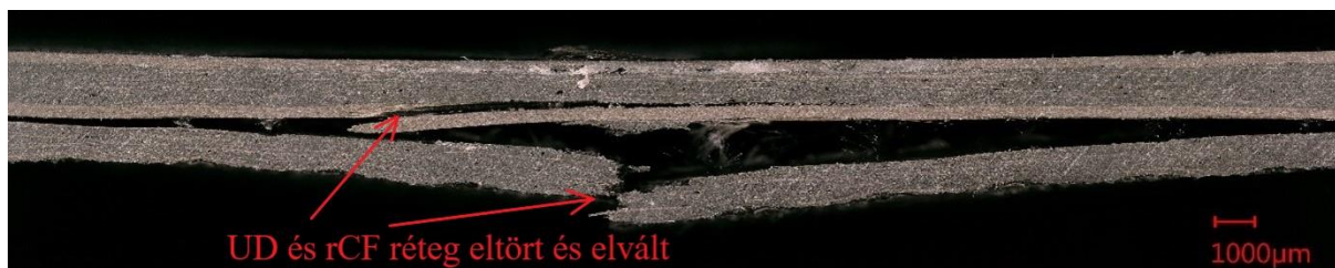
32. ábra – ENF próbatetek mikroszkópi felvételei: a) [0/0/0/0/0], b) [0/90/0/90/0]; eltört és elvált rétegek pirossal jelölve
