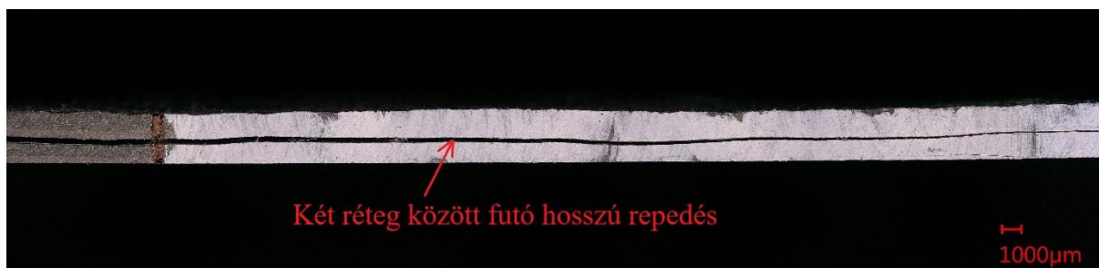
33. ábra – ENF próbatetek mikroszkópi felvételei: a) [0/0/0/0/0], b) [90/0/90/0/0]; repedési út pirossal jelölve
