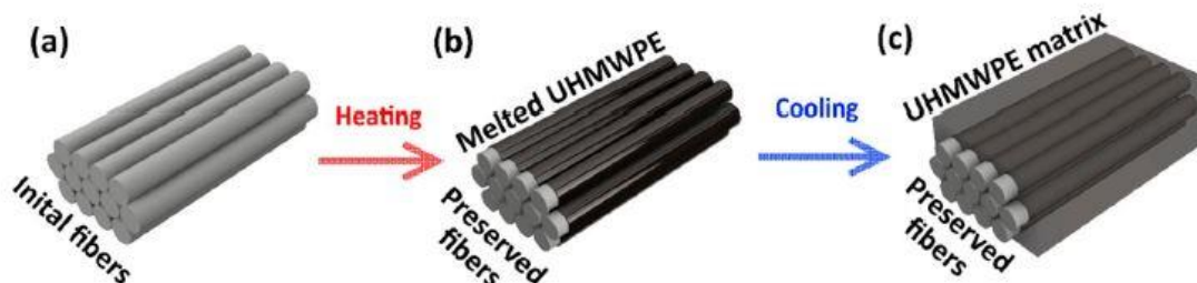
13. ábra az önerősítéses UHMWPE kompozit előállításának sematikus ábrája [11]
