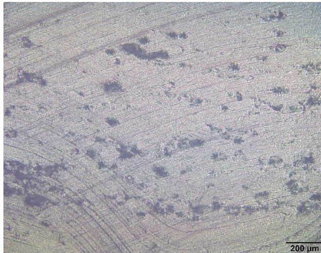
28. ábra 50 térfogat% száltartalommal szinterezett minta fénymikroszkópi képe
