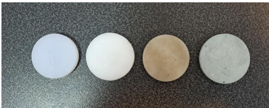
29. ábra Szinterezett próbatestek tribológiai vizsgálatához, balról sorban a referencia töltetlen, általam gyártott töltetlen, 25 térfogat% száltartalom és 50 térfogat% száltartalom
