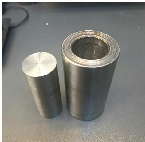
24. ábra A 32 mm átmérőjű próbatest szinterezésére alkalmas szerszám
