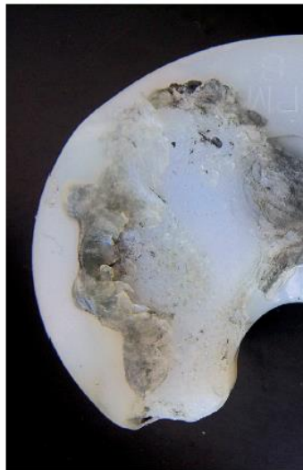
2. ábra Revíziós úton eltávolított, UHMWPE alapanyagú delaminálódott protézis [6]
