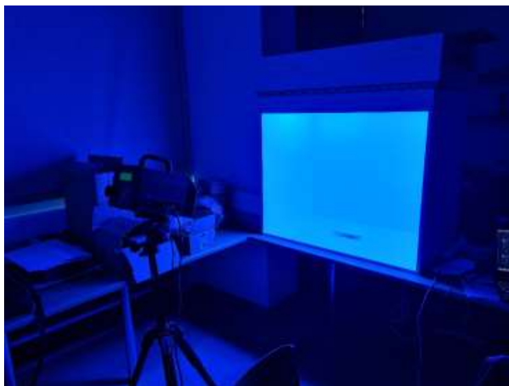
2-13. ábra: LED-es fénykabin kalibráció működése kalibráció alatt (Forrás: Saját felvétel)
