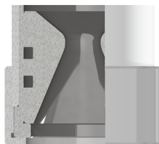
7. ábra. KRATOS-54T rakétamotor fúvókája és rögzítő-gyűrűje
