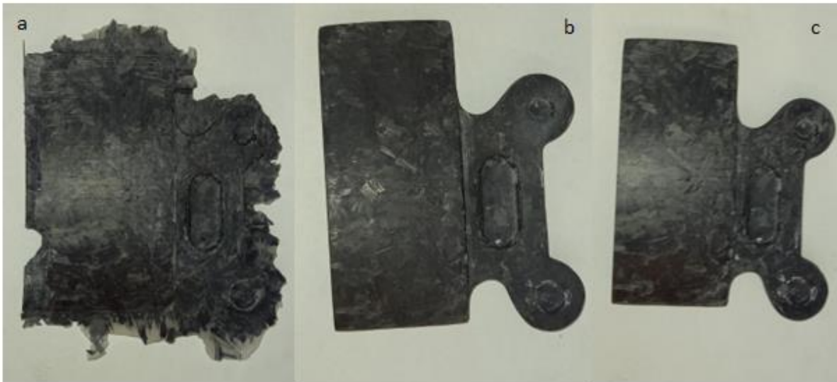
43. ábra A termék szerszámbontás utáni (a), szélézési utáni (b) és csiszolás utáni (c) állapota
