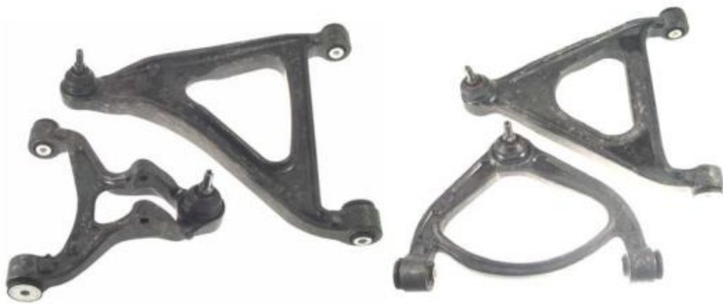
9. ábra A Lamborghini Sesto Elemento felfüggesztésének vezérlőkarjai [23]
