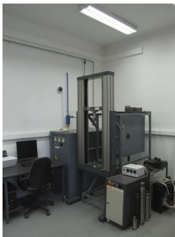
12. ábra Zwick Z050 szakítógépet [34]
