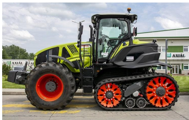
10.Ábra: Kerekes és erővel záró gumihevederes hajtás ugyanazon a traktoron Claas fejlesztés
