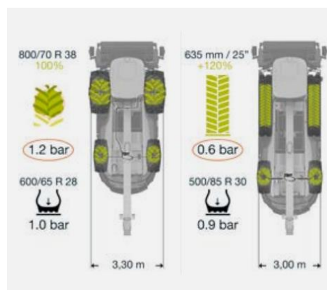
37.Ábra: Adott felfekvő felület és az ahhoz tartozó talajnyom
