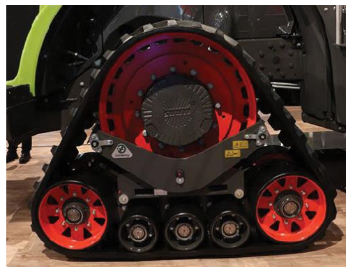
50.Ábra: Claas Xerion 5000 Gumihevederes hajtás
