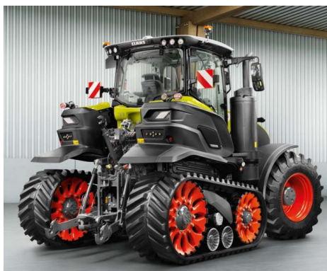
10.Ábra: Kerekes és erővel záró gumihevederes hajtás ugyanazon a traktoron Claas fejlesztés
