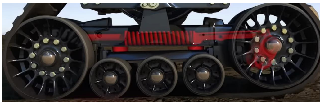
57.Ábra: CASE IH támasztógörgők rugalmas felfüggesztés
