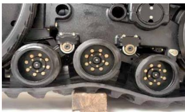
29.Ábra: Támasztó görgők szerepe a hevederes járószerkezetben
