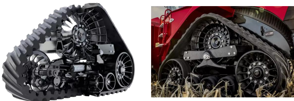
52.Ábra: Case IH Hevederes járásrendszer metszet
