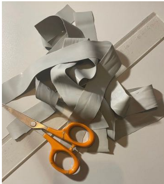
4-3. ábra. A ballon leeresztéséért felelős gumiszalagok
