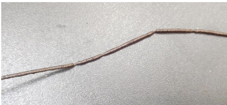
13. ábra A filamentgyártás során a mátrixanyagban szegény részeken szakadás alakulhat ki
