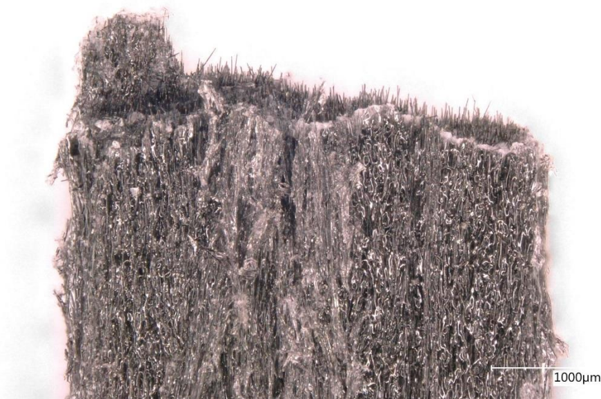
24. ábra 10 m% szénszálat tartalmazó minta mikroszkópos képe
