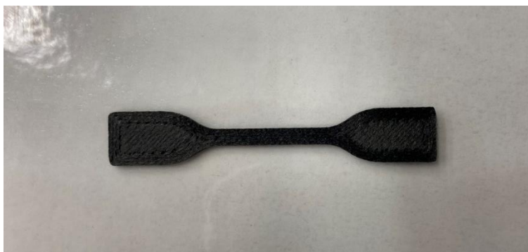
16. ábra A gyártott próbatest
