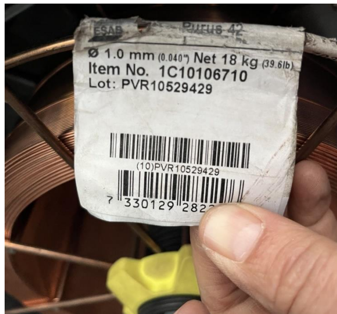
7.ábra: Purus 42 huzalelektroda a huzalelőtőlóban
