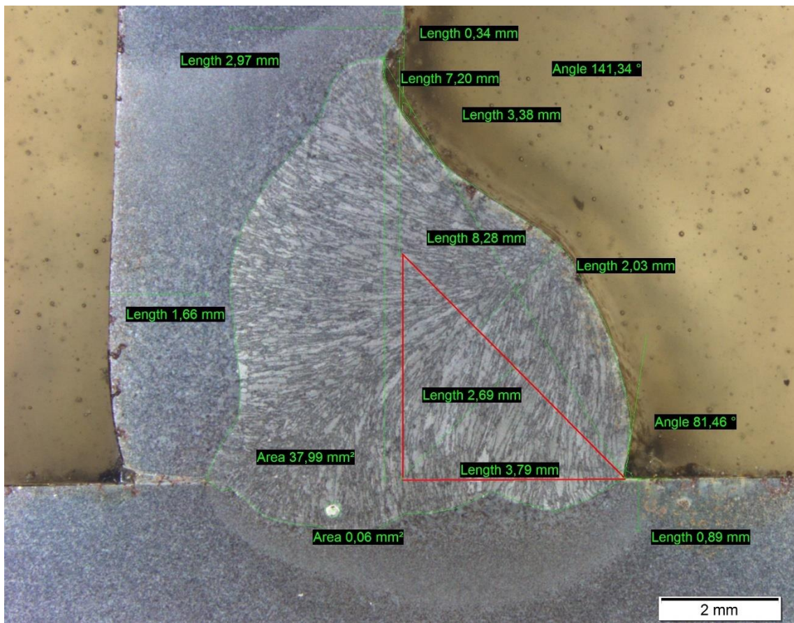
17.ábra: 5. jelű sarokvarrat geometriája.
