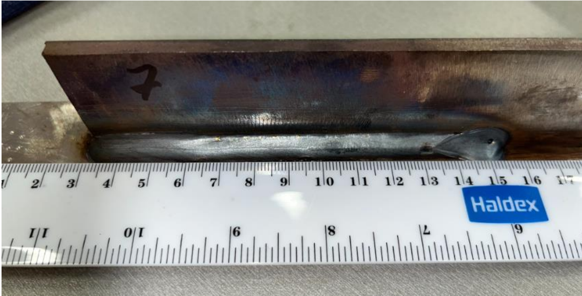
M7. ábra: 4. jelű sarokvarrat koronaoldala
