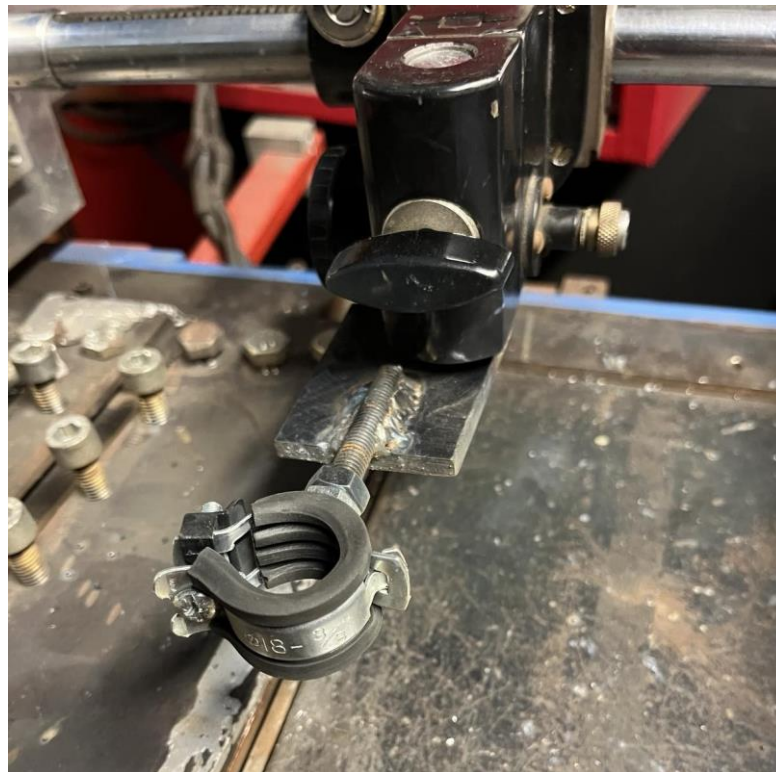
6.ábra: a már dönthető pisztolybefogó
