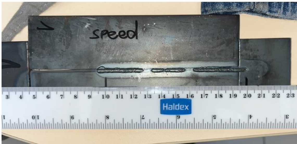
M1. ábra: Az 1. jelű tompavarrat gyökoldala
