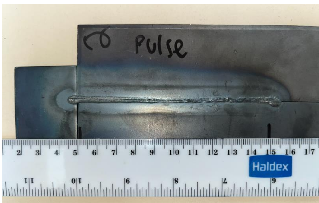
M2. ábra: A 2. jelű tompavarrat gyökoldala.
