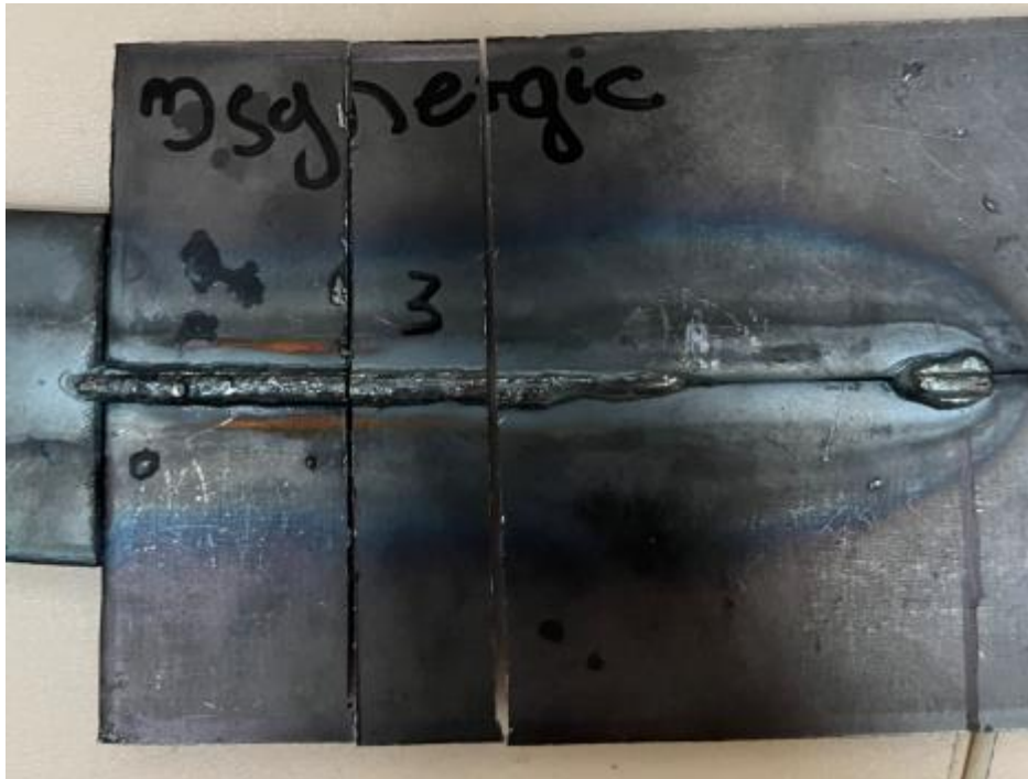
M3. ábra: A 3. jelű tompavarrat gyökoldala, már darabolás után
