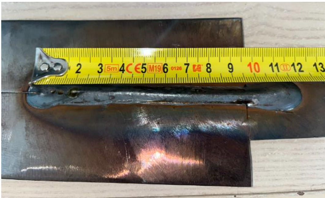
M6. ábra: 3. jelű tompavarrat koronaoldala
