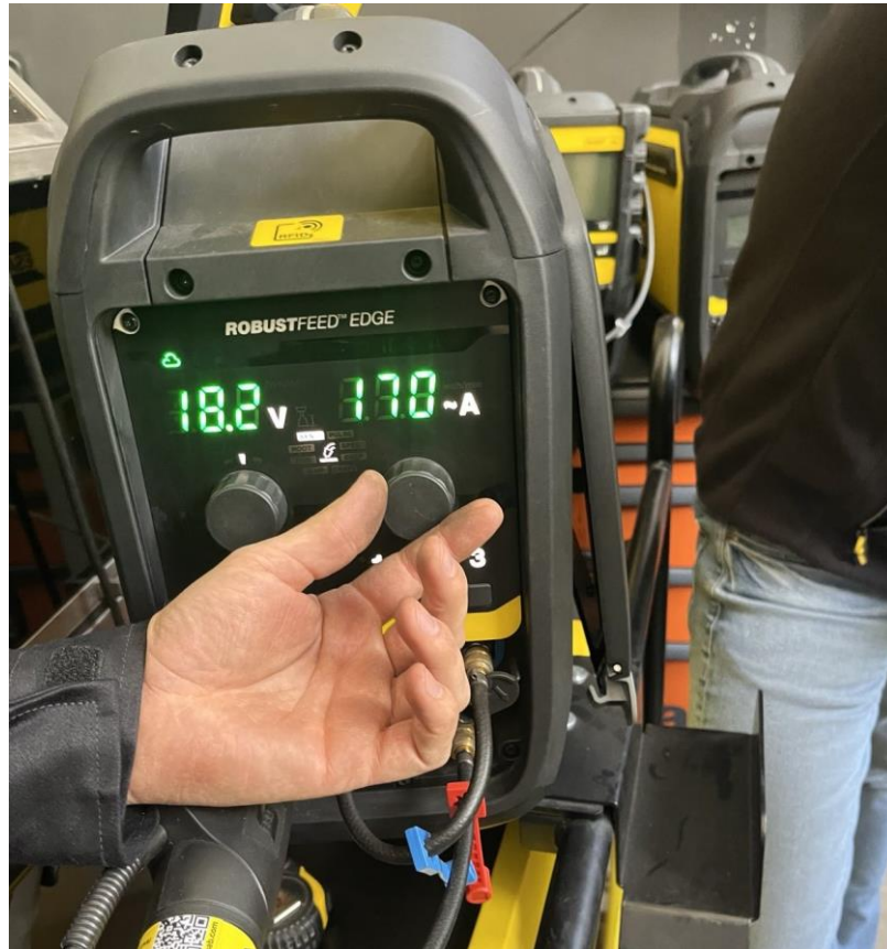
9.ábra: Paraméterek állítása az előtolon
