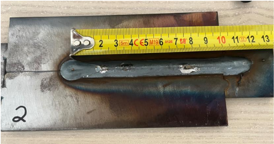
M5.ábra: 2. jelű tompavarrat koronaoldala.
