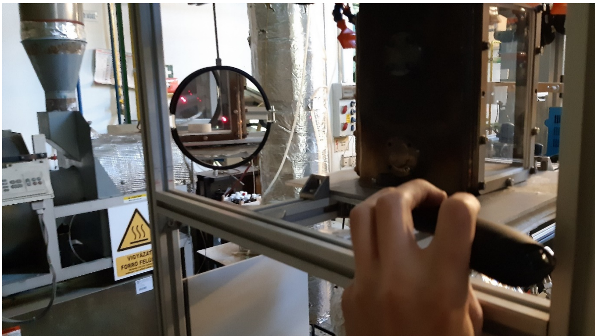
9. ábra: Schlieren parabolatükör irányának beállítása
