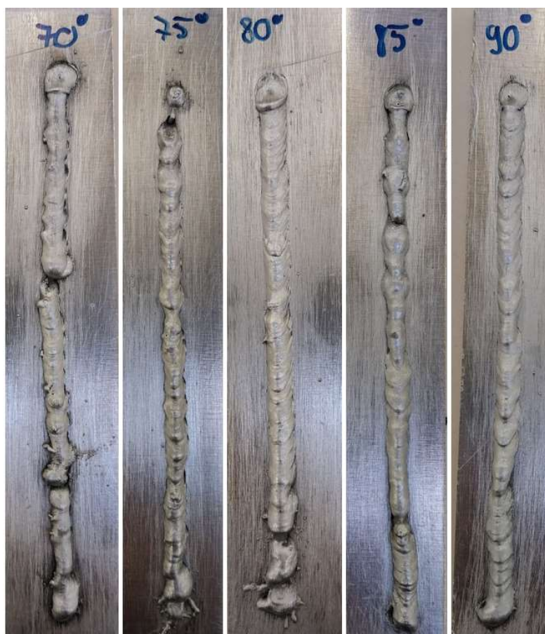
12. ábra: Az első kísérletsorozat, mely egyenetlen varratkoronájú, esztétikailag kifogásolható varratokat eredményezett
