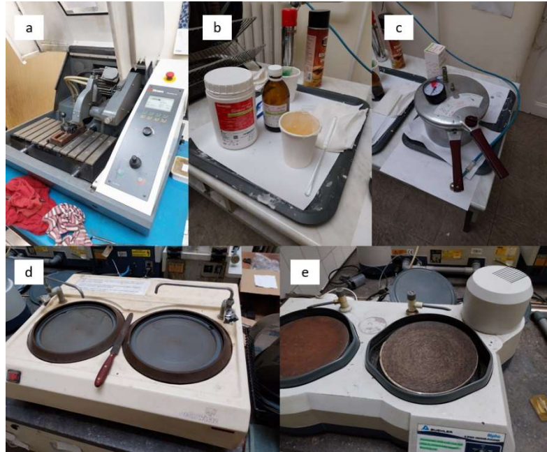
11. ábra: a) vágógép, b) hidegbeágyazáshoz használt anyagok és eszközök, c) csiszolóberendezés, d) polírozógép, e) elszívó berendezés, f) sztereomikroszkóp
