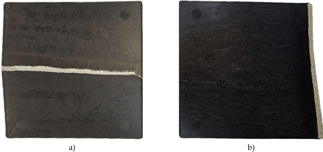
12. ábra A folyásirányban (a) és a folyási út végére (b) helyezett fémhab lemezzel gyártott próbatest
