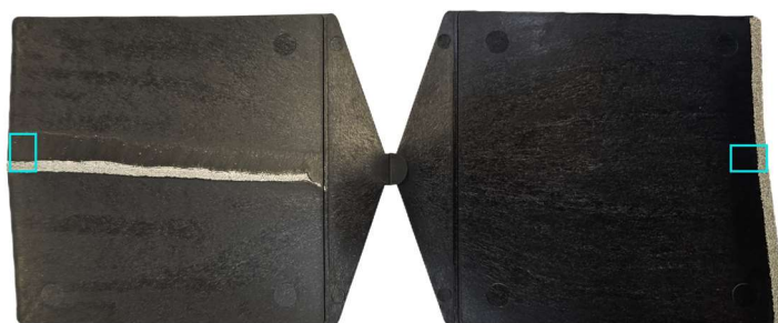
31. ábra A SEM minta kimunkálásának pozíciói a lapka próbatest esetén
