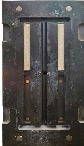
10. ábra A fémhab darabok behelyezése a szerszámüregbe
