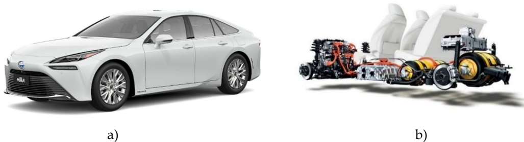
2. ábra A második generációs hidrogénhajtású Toyota Mirai (a) és az autó hajtásrendszere (b) [13]
