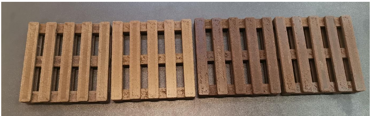
15. ábra Nyomatott raklap próbatest színhatása (balról haladva növekvő falisztartalommal)
