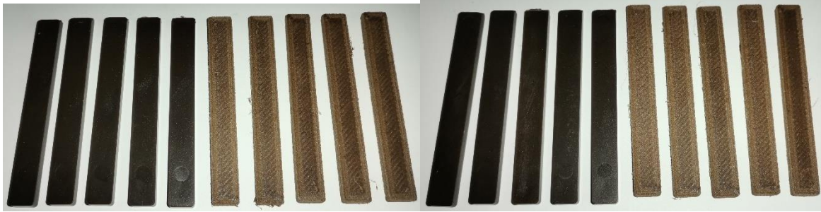
22. ábra Fröccsöntött (balra) és nyomtatott (jobbra) PLA hajlító próbatestek 5 m% (a), 10 m% (b), 15 m% (c) és 20 m% (d) falisztartalom mellett
