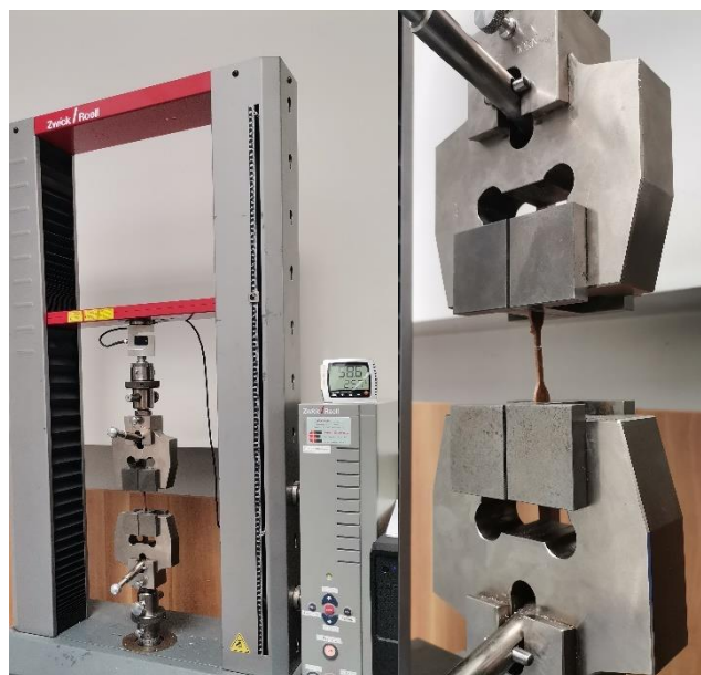
7. ábra Univerzális szakítógép (a) és ék formájú befogófej (b)
