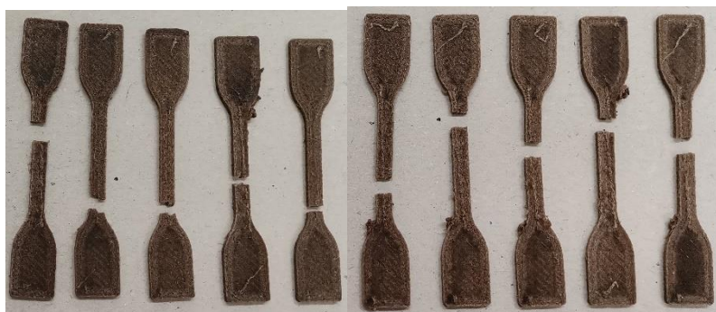
18. ábra Vizsgált próbatestek 5 m% (a), 10 m% (b), 15 m% (c) és 20 m% (d) falisztartalom esetében
