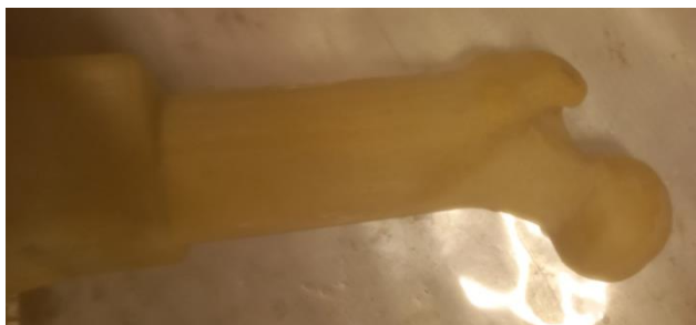
49. ábra Elkészült poliuretán combcsont
