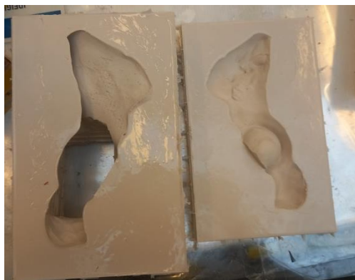
48. ábra Kész medence öntőforma
