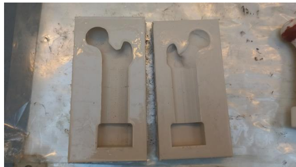
47. ábra Kész combsont öntőforma
