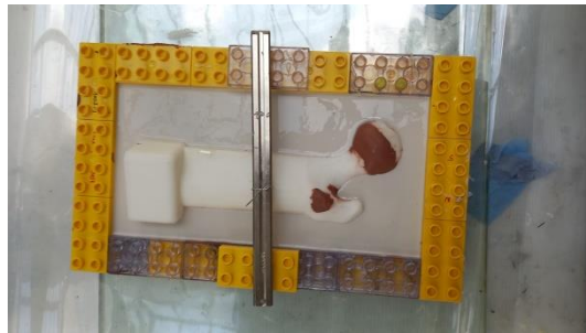
45. ábra Félkész combsont öntőforma
