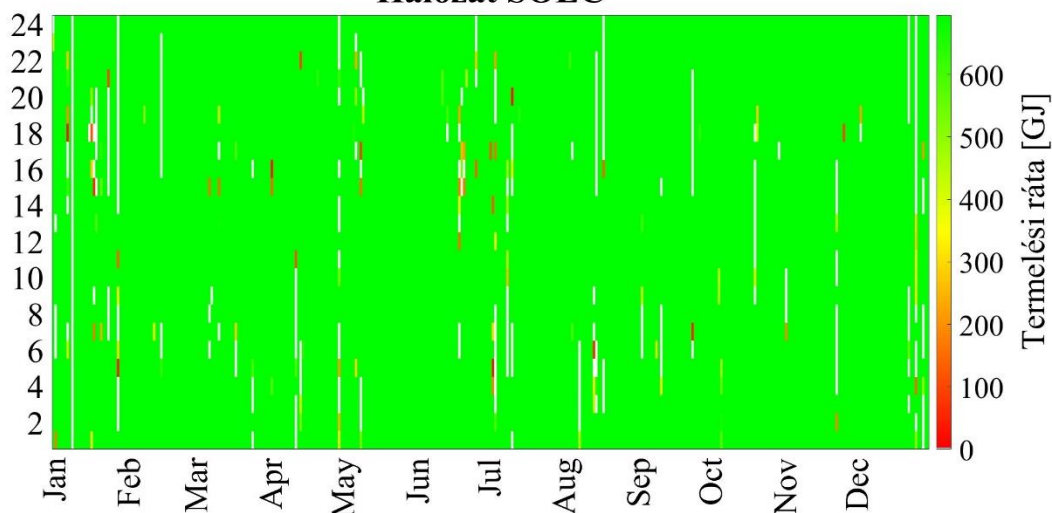
10. ábra Elektrolizálók működése közvetlenül a hálózattól táplálva (felül AEC, középen PEM, alul SOEC)
