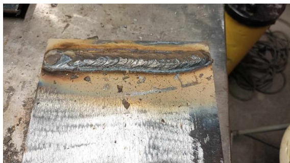
a.) Capilla 5400 elektródával készített hernyóvarrat tisztítás előtt
