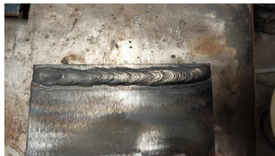
b.) Capilla 5400 elektródával készített hernyóvarrat tisztítás után
