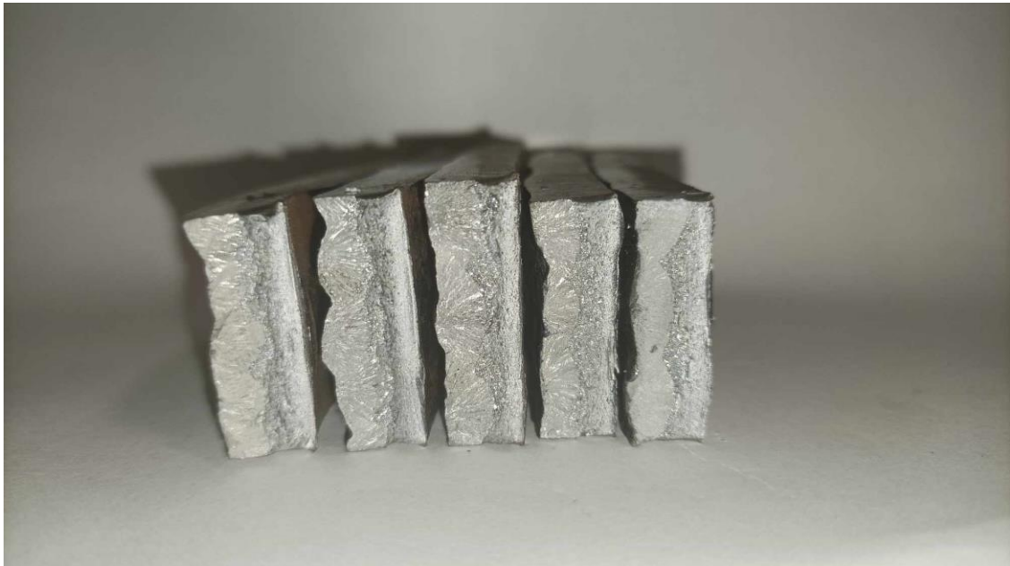
20. Ábra – Hajlító próbatestek töret felülete (próbatestek balról jobbra: 2709, 6500, 5400 ,6500-edzett, 5400-edzett)
