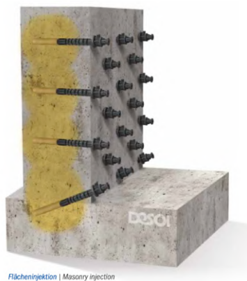
70. ábra: Tömbinjektálás sémája (30)
