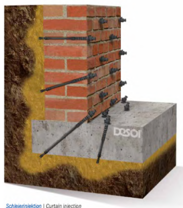
72. ábra: Fátyolinjektálás sémája (30)
