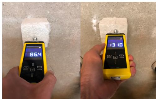
19. ábra: Felületi sószakáll hatása a mérési eredményekre
