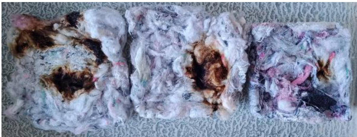
68. ábra: felső felülete (balról jobbra 10, 20 és 30 gramm kálivízüveggel)
