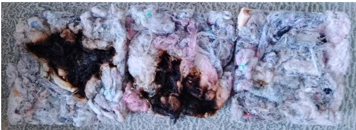
62. ábra: felső felülete (balról jobbra 10, 20 és 30 gramm nátronvízüveggel)
