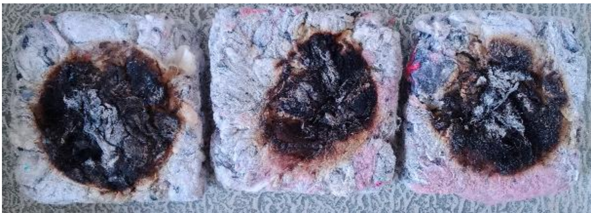
65. ábra: lángnak kitett oldalon (balról jobbra 10, 20 és 30 gramm nátronvízüveggel)
