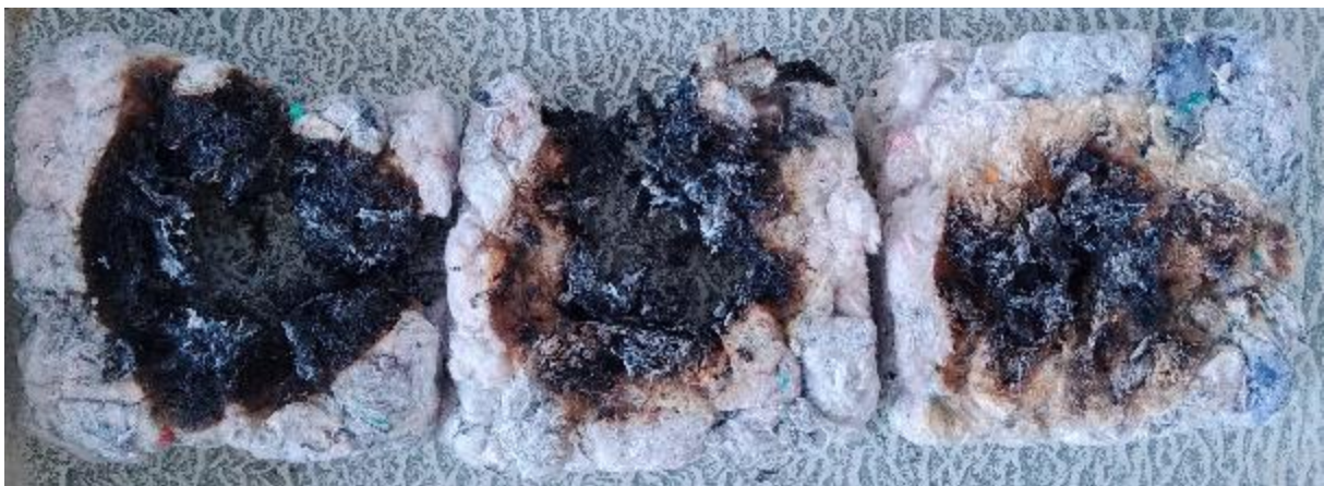
67. ábra: lángnak kitett oldalon (balról jobbra 10, 20 és 30 gramm kálivízüveggel)
