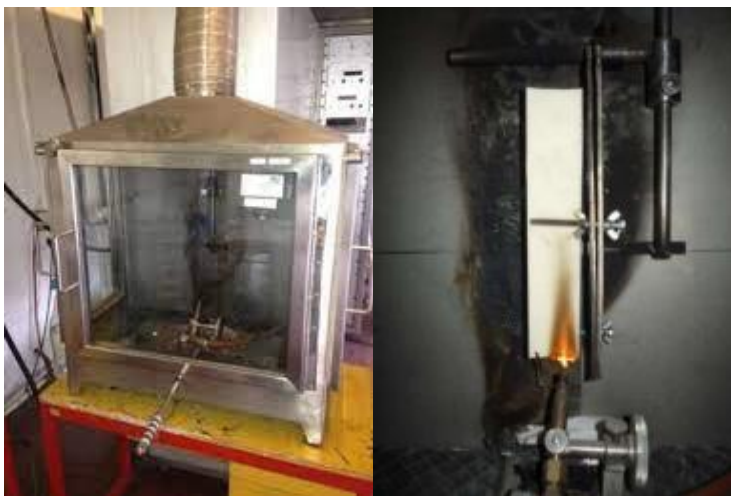
1-2. ábra: egyedi lángforrásos vizsgálat vizsgálókamrája [7]
