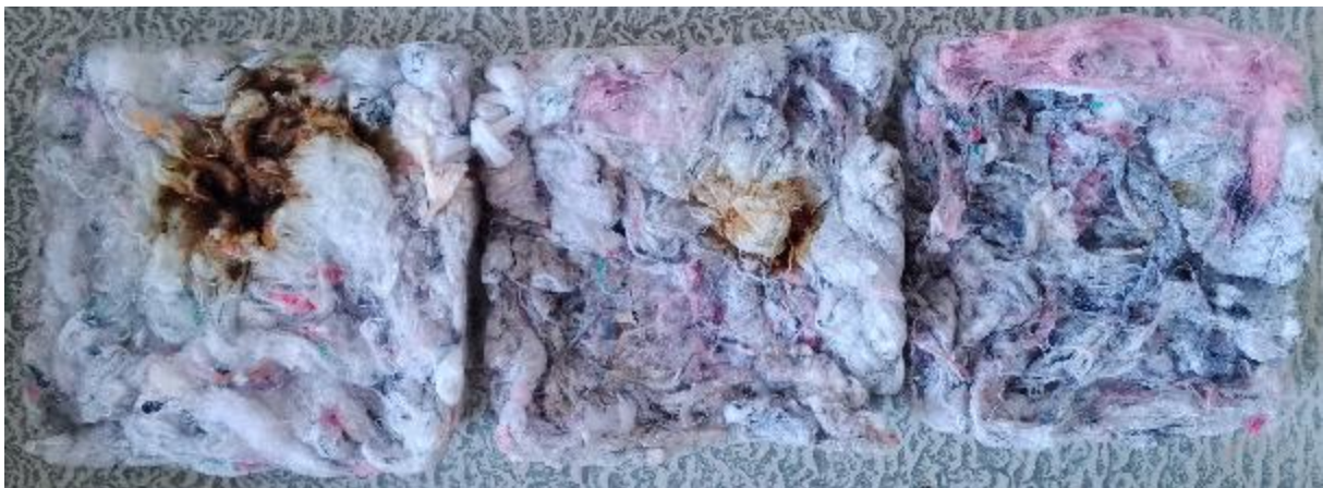
64. ábra: felső felülete (balról jobbra 10, 20 és 30 gramm nátronvízüveggel)
