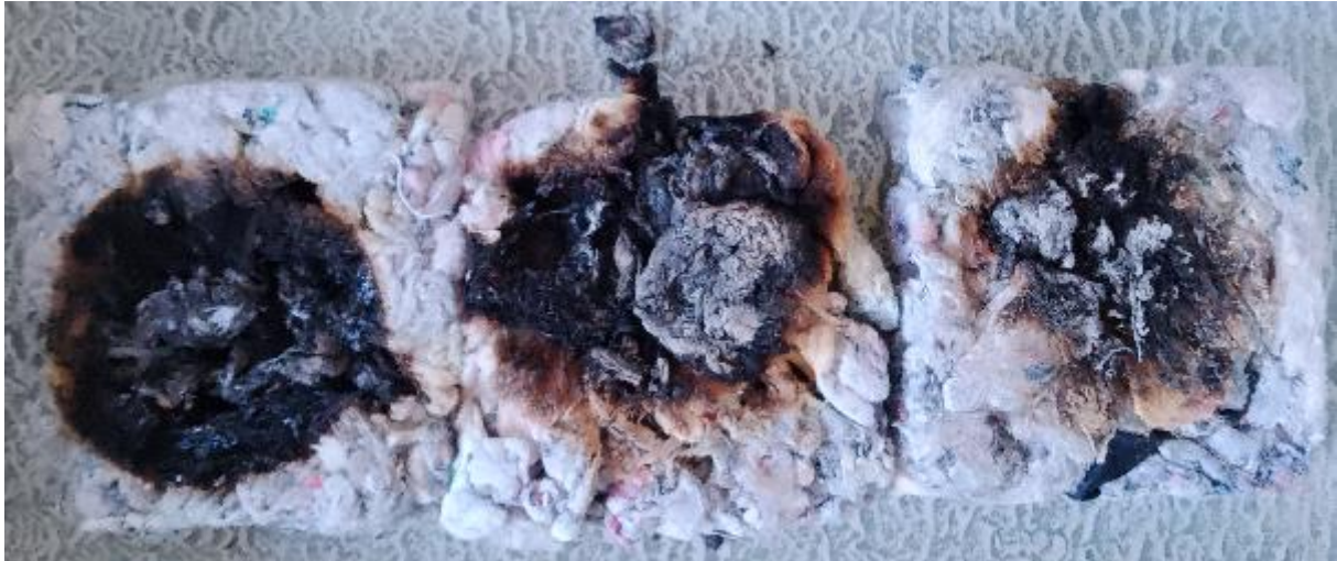
63. ábra: lángnak kitett oldalon (balról jobbra 10, 20 és 30 gramm nátronvízüveggel)
