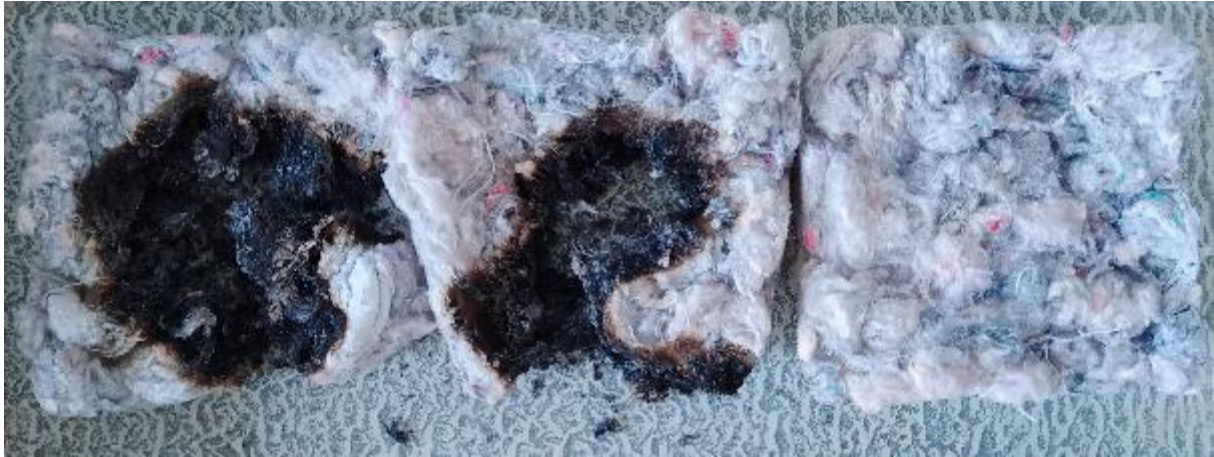
66. ábra: felső felülete (balról jobbra 10, 20 és 30 gramm kálivízüveggel)
