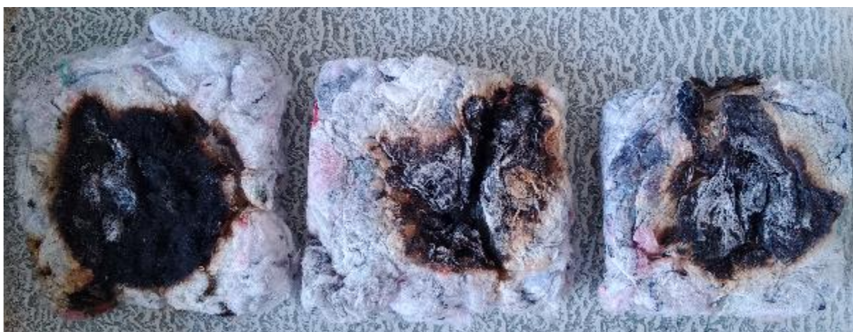
69. ábra: lángnak kitett oldalon (balról jobbra 10, 20 és 30 gramm kálivízüveggel)
