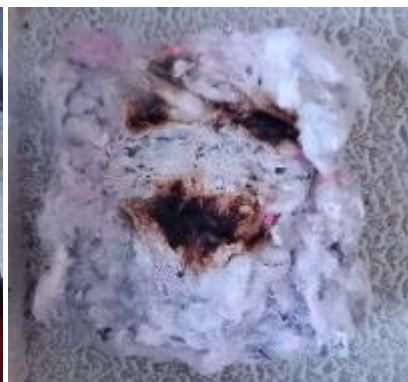
49. ábra: a 6. percben még izzik a belseje
