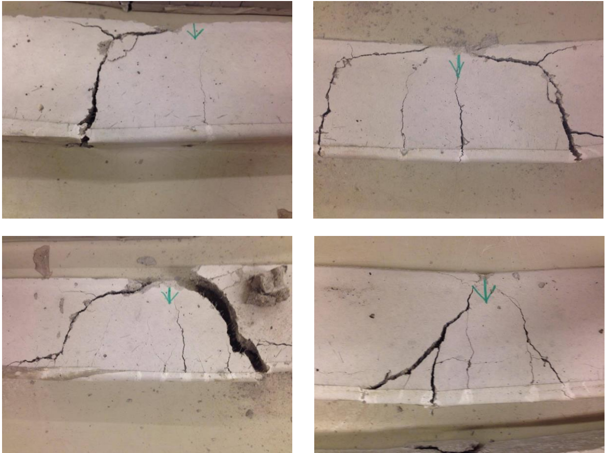
21. ábra - Szálerősítésű, hosszanti vasalással rendelkező gerendák törésképei; bal felső: SZ1, jobb felső: SZ2, bal alsó: SZ3, jobb alsó: SZ4 [saját képek]
