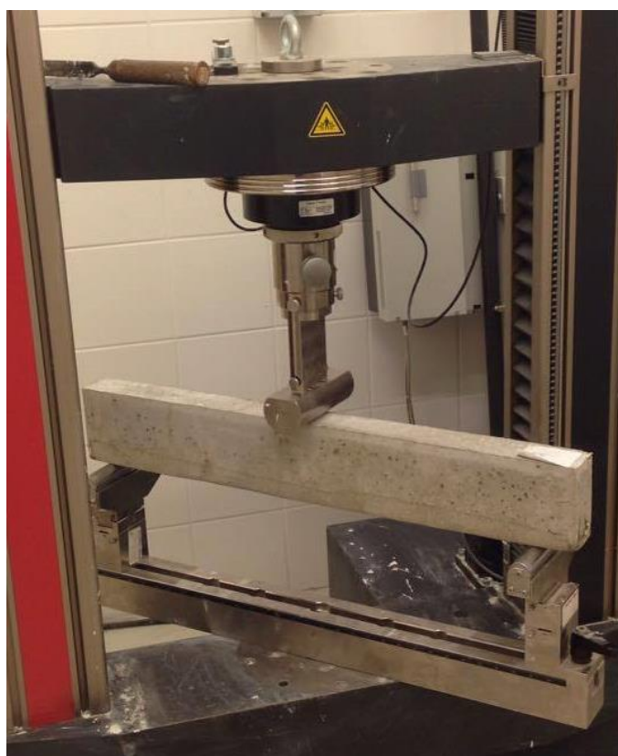
10. ábra – ZWICK Z-150-es típusú univerzális törőgép [saját kép]
