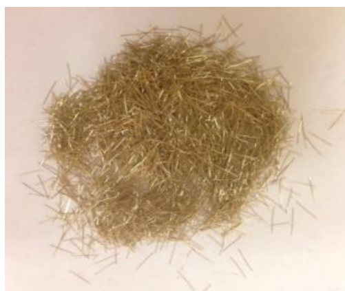
8. ábra – Alkalmazott rövid acél szálak [saját kép]
