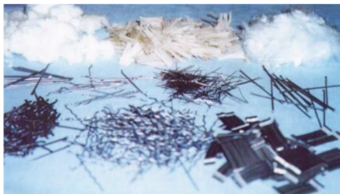
7. ábra- Különböző anyagú szálak [sinekvilaga.hu]
