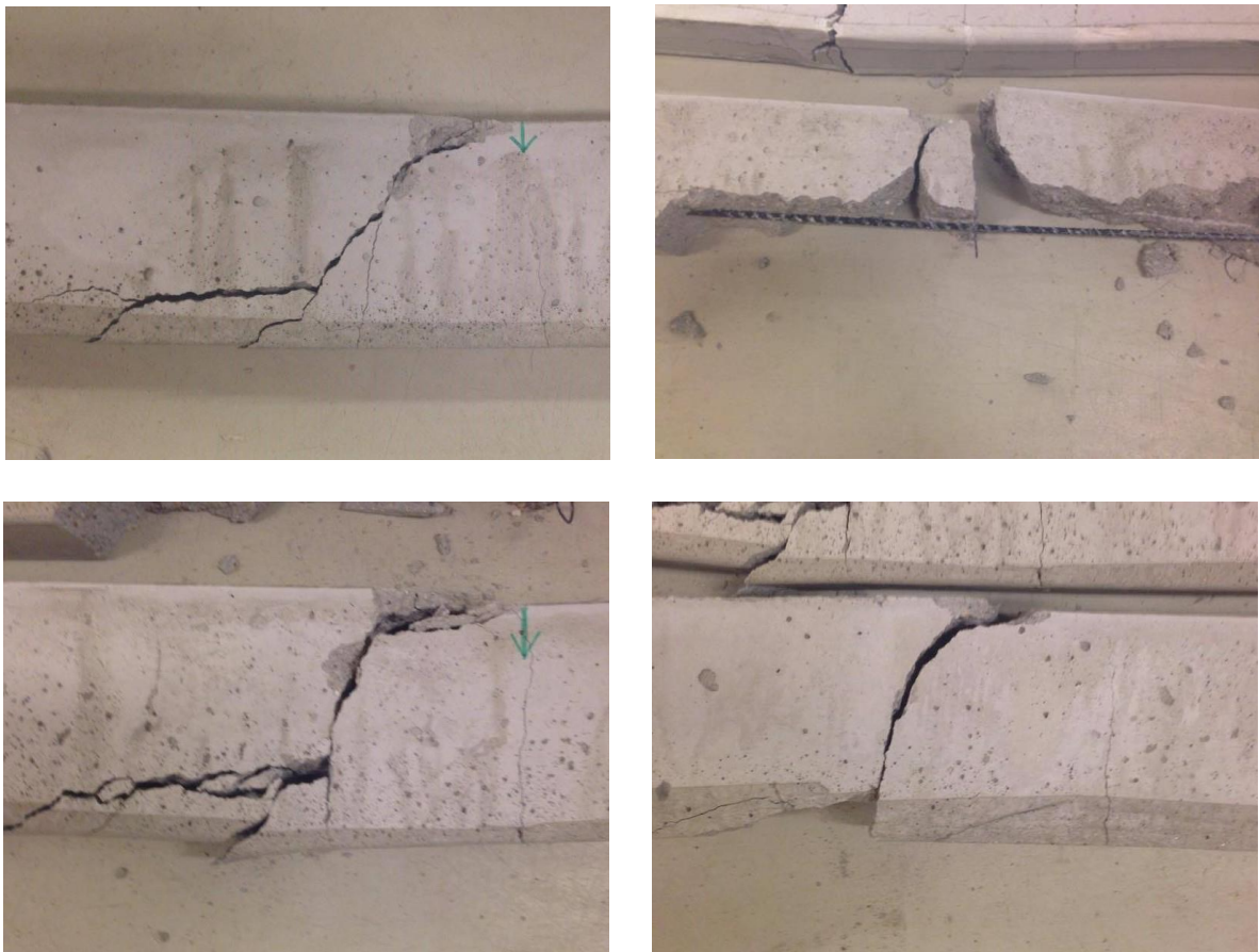
19. ábra – Szálak nélkül, hosszanti vasalással rendelkező gerendák törésképei; bal felső: N1, jobb felső: N2, bal alsó: N3, jobb alsó: N4 [saját képek]
