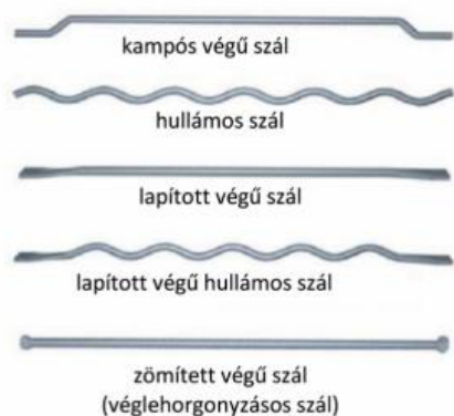
6. ábra- Különböző alakú acélszálak [sinekvilaga.hu]
