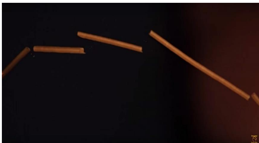
2. ábra: Ívesre hajlított spagetti négy töréses fragmentációja nagysebességű kamerával [4]
