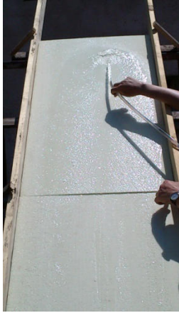
10.kép: A nulla kezdősebességű pont meghatározásához a slagot fölfelé irányítottuk
