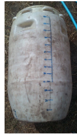
13.kép: A puffertartály kalibrálása
