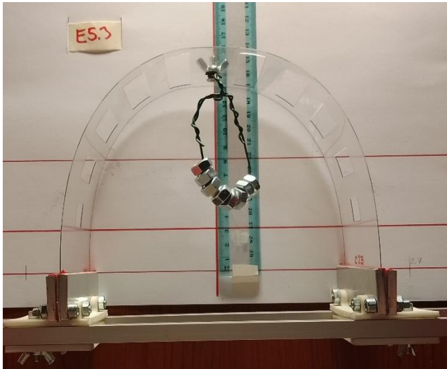
9. ábra. Egy vizsgált lemez alakváltozása 38g teher alatt, b=1/2 \times l támaszközön (A felirattal ellenben ez a B5 minta alakváltozása)
