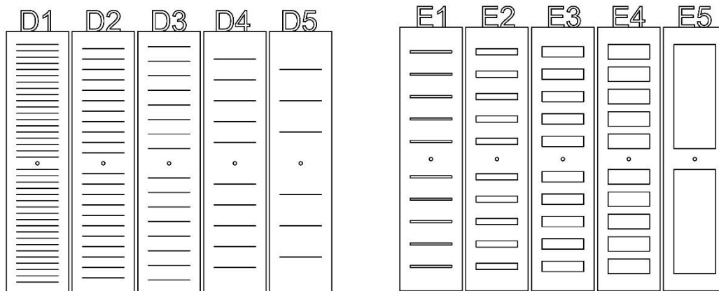
5. diagram. D és E minták (14. ábra) merevsége és porozitása b=1/2 \times l támaszközön, F=0,38N erő alatt, 3 mérés átlaga. Ez egybevág a [2] szakirodalommal, mely azt állítja, hogy a merevség és a porozitás fordítottan arányos
