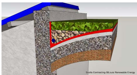
(47) Scotts Contracting épületének zöldtető rétegröndje
