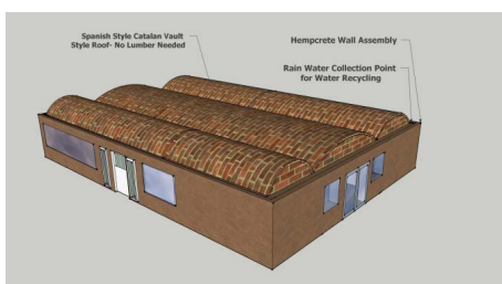
(46) Scotts Contracting kenderbeton háza Katalán fedéssel
