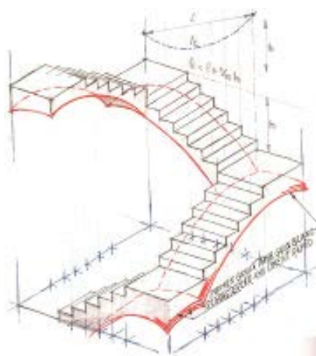
(25) Parabola szerkesztésű Katalán lépcső
