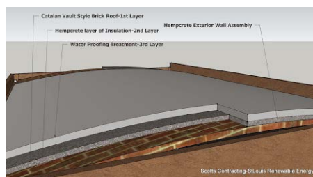
(49) Scotts Contracting lapos ívű tetőjének rétegrendje
