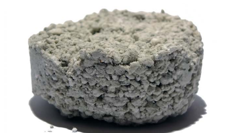
(80) Gipsszel ragasztott perlit mintadarab
