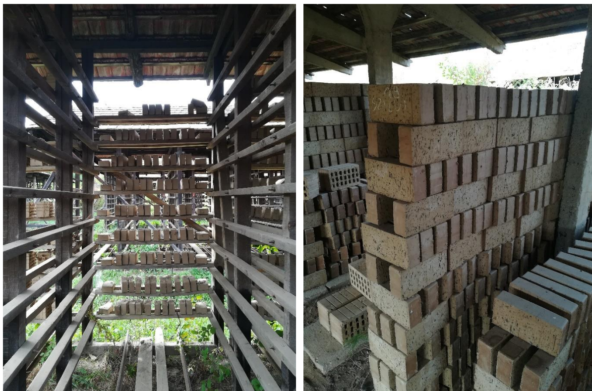
9. ábra: bal: Szárítás Keller-rendszerű szárítóban, jobb: Szárítás közönséges szárítószínben
