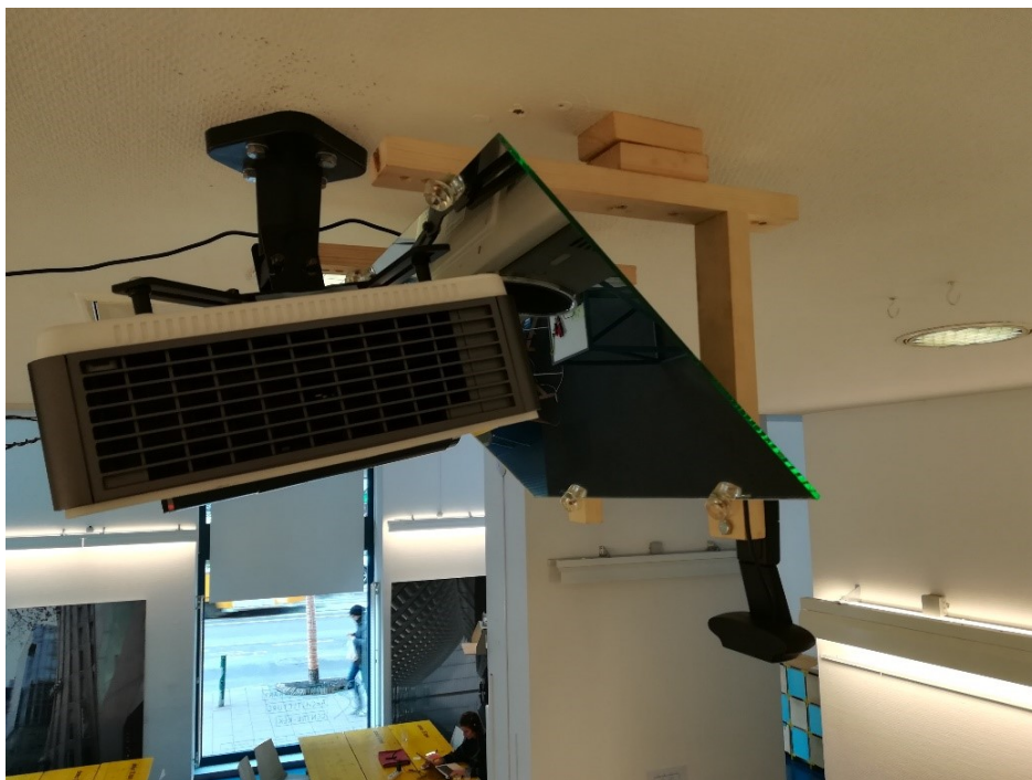
A projektor, a tükör és a kamera egymáshoz viszonyított helyzete és rögzítésük.
