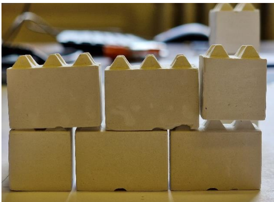
46. kép Hibás falazat nagy pozicionáló gúlás elemmel
