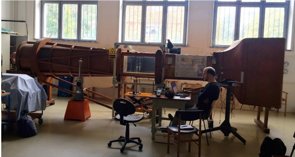
5 kép: A Kármán Tódor Szélcsatorna Laboratórium NPL típusú szélcsatornája, melyet az anemométerek kalibrálásához használtunk
