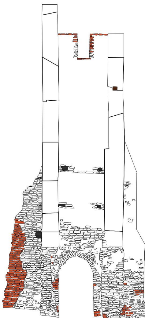
65. kép. Kelet-nyugat metszet déli irányban az állagmegóvásokkal jelölve. Saját CAD-rajz
