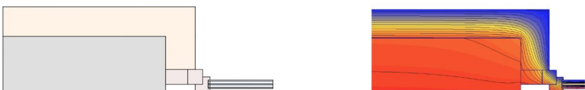
15. ábra: Hőszigetelt falszerkezet, beépítési sík a falazat belső síkja
