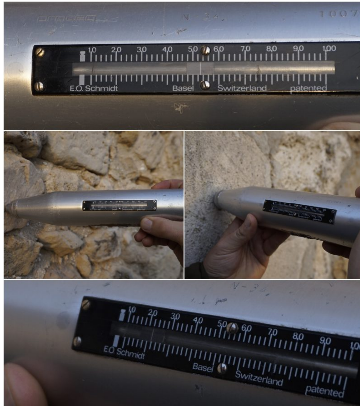
› 9. ábra: A helyszínen alkalmazott Schmidt kalapácsos mérések a falban eredetileg beépített durva mészkövön és egy rekonstrukció során beépített sóskúti durva mészkövön. A felső kép az eredetileg beépített, míg a legalsó kép a pótlás értékét mutatja.
