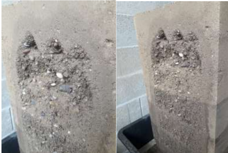
36.- 37. ábra Az elkészült falazat natúr oldaláról készült fotók a vizsgálat után [saját fotó]
