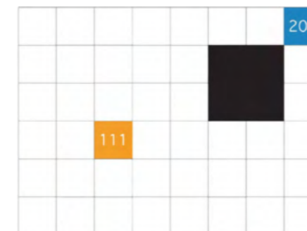
44. ábra - Pont-mélység elemzés (point-depth analysis): az átlagos mélység (mean depth) kiszámítása két különböző kiinduló cellából és különböző helyzetekben elhelyezett akadállyal 39 (forrás: van Nes és Yamu)
