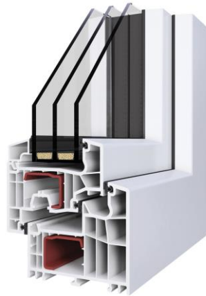
3. kép: Az ablakok külső csapadékszáróságát nagy alakváltozási képességű "embrió"- vagy ún. "lengőnyelves" EPDM profilokkal érik el.
