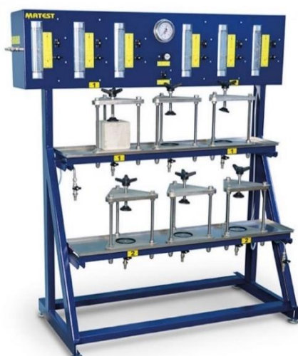
9. kép: A MATEST C435-01 Concrete water impermeability apparatus és annak működési sémája
