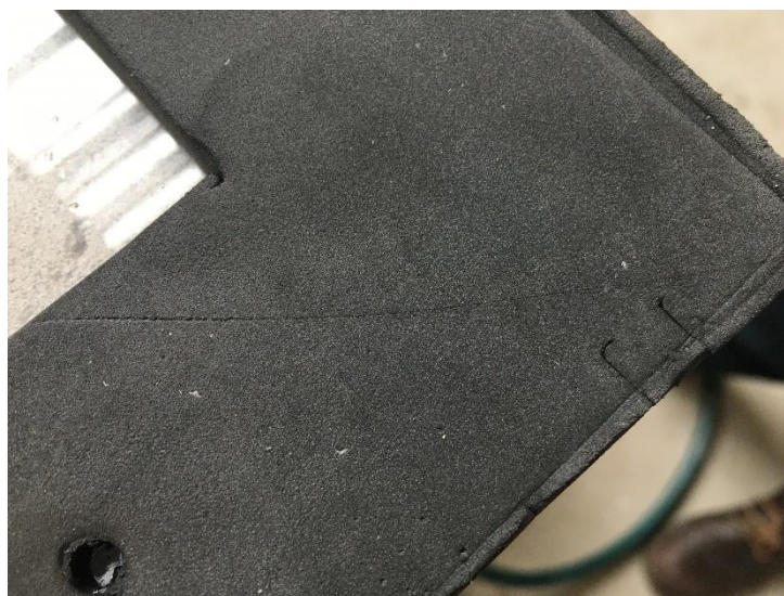
8. kép: Vonalmenti sérülés a tömítőanyagban; jól látszik az összenyomódás-különbség a tömítés szélén.
